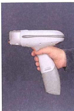
analyseur par fluorescence X à tube à électrons NITON
