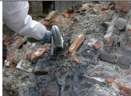
Mise en œuvre du NITON sur site
