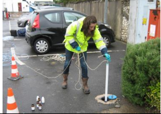
Prélèvement au bailer (préleveur jetable)
