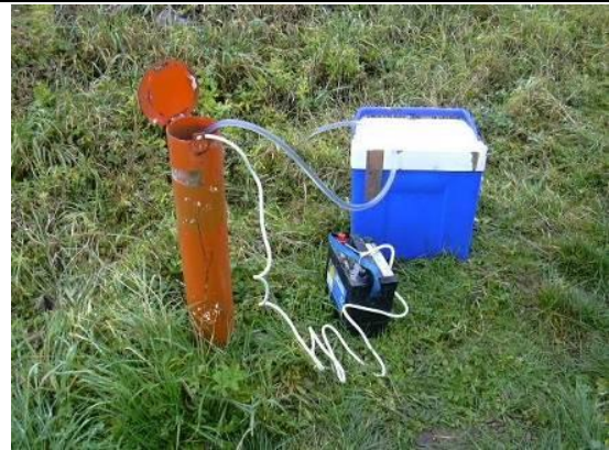
Développement par pompage
