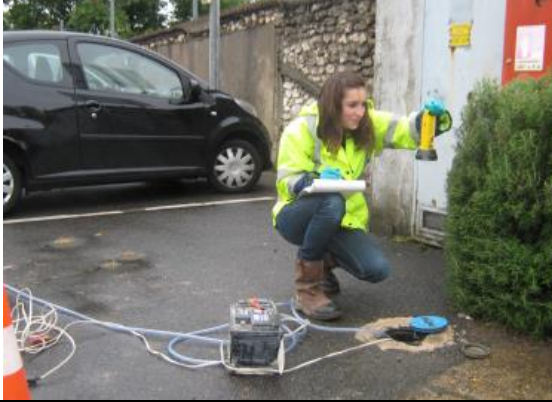
Mesure du pH, Conductivité, redox et température
