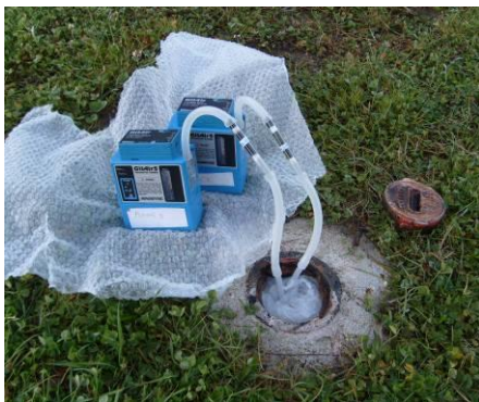
Prélèvement actif avec deux pompes
