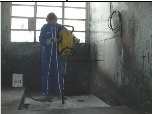
Sondage au carottier à percussion
