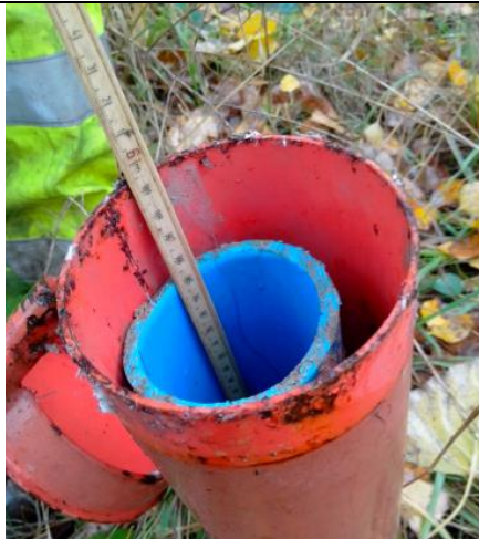
Mesure du niveau statique
