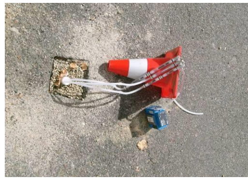
Prélèvement actif avec une pompe et porte tubes
