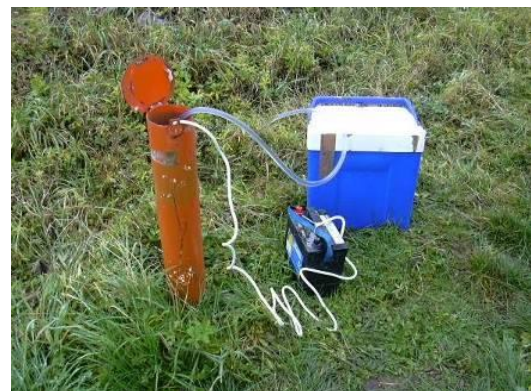
Purge à l'aide d'une pompe électrique immergée
